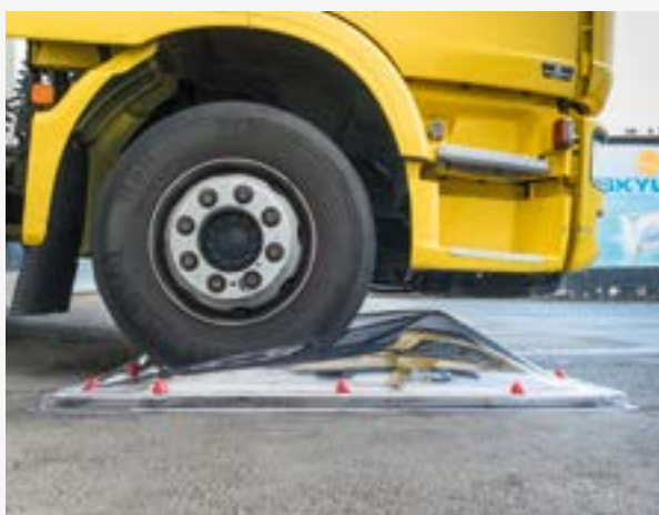
Test mit Skylux Panzerkuppel aus Polycarbonat: Die Kuppel zerbricht nicht, sondern geht ohne Schaden wieder in die ursprüngliche Form zurück.
