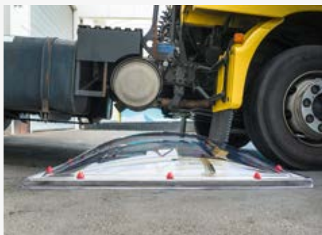
Test mit Skylux Panzerkuppel aus Polycarbonat: Die Kuppel zerbricht nicht, sondern geht ohne Schaden wieder in die ursprüngliche Form zurück.
